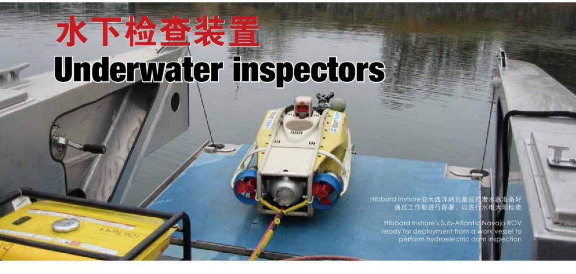
来自Hibbard Inshore公司的Dave Malak报道,该公司的遥控潜水器技术使得机器人能够对水力发电和海上可再生能源发电厂进行水下评估
